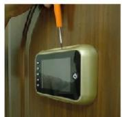
**Шаг 4.** Установите 4 батарейки типа «АА» во внутренний модуль устройства и подключите к нему кабель, идущий от внешнего модуля.
