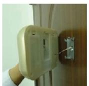
**Шаг 3.** При помощи отвертки вкрутите шуруп через отверстие кронштейна в отверстие на внешнем модуле, тем самым надежно скрепив внутренний кронштейн с внешним модулем.
