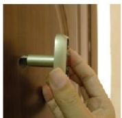
**Шаг 1.** Удалите защитный слой с клейкой ленты на задней поверхности внешнего модуля. Вставьте внешний модуль вместе с кабелем FPCB в установочное отверстие для дверного глазка на двери и прижмите его к двери.
