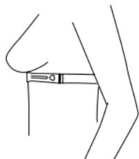
Слегка приподнимите ремень спереди. Смочите ребристые участки (электроды) с обратной стороны датчика слюной или водой.
