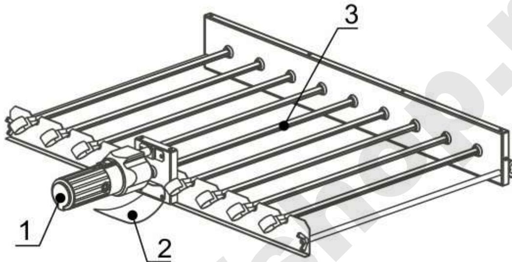
Основные отличия от остальных моделей, являются: расположение мотора(1); отражателя(2); наличие переходного вала(3) – устанавливается в процессе сборки.
