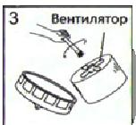
Почистите среднюю часть и вентилятор при помощи специальной щетки. Также можно протирать их влажной салфеткой.
