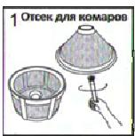
Выньте сетчатый отсек. Чистить ловушку следует снизу вверх. Снимите отсек для комаров и почистите его круговыми движениями.
