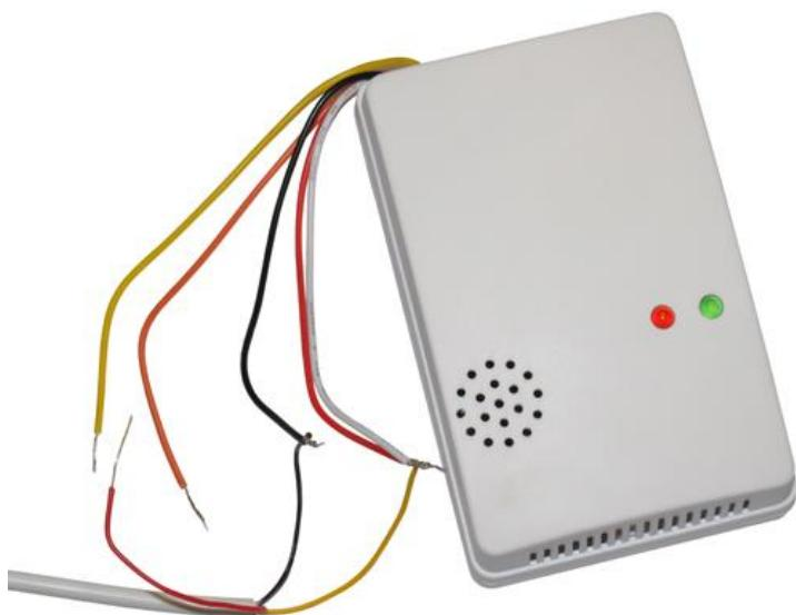
Соедините черный провод кабеля (в комплекте) с черным проводом датчика. Соедините желтый провод кабеля с красным и белым проводами датчика одновременно (см. иллюстрацию).
