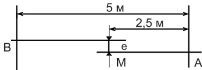
Повернуть лазерный построитель так, чтобы сместить луч приблизительно на 2,5м влево и проверить, чтобы горизонтальная линия находилась в пределах значения „точность” (см. характеристики) на той же высоте, что и нанесенная отметка, указанная лазерным крестом. Повторить эти же действия , смещаая лазерный инструмент вправо. Внимание: ось вращения при проверке точности не смещайте.
