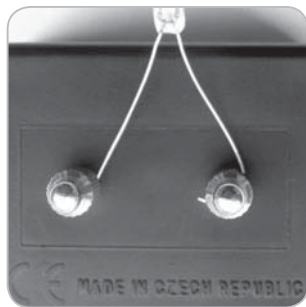
Правильное расположение тестовой лампы
