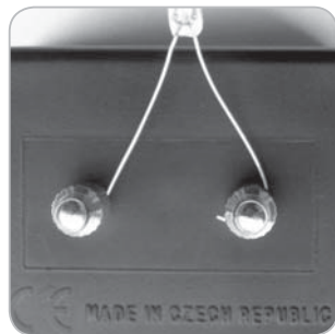
Правильное расположение тестовой лампы
