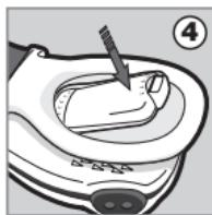
4. Doe de nieuwe batterij erin en zorg u ervoor dat de polen van de batterij correct zijn (het positieve eind '+' van de batterij moet overeen komen met het '+' symbool in de batterij-opening, zoals aangegeven). Vervang de batterij-omslag en zorg ervoor dat deze correct is gesloten.
