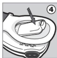
4. Inserte la nueva batería, asegurándose de que la polaridad sea correcta (alinee el extremo positivo "+" de la batería con el símbolo "+" donde le corresponde). Vuelva a poner la tapa de la batería y asegúrese de que esté cerrada correctamente.
