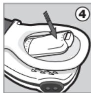
4. Insérez la nouvelle batterie, veiller à ce que la polarité (la borne positive de la batterie (signe '+') positionné sur le symbole '+' gravé dans le logement de la batterie). Replacez le couvercle de batterie assurer vous qu'il est correctement fermé.
