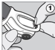
2. Dès que le clip a été retiré vers l'arrière sur 1 mm, le couvercle de la batterie doit s'ouvrir. Une protection de clip (10) empêche une flexion trop importante du clip. Ne pas essayer de plier le clip au-delà de cette protection.
