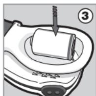
3. Entfernen Sie die leere Batterie.
