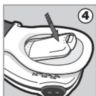
4. Legen Sie die neue Batterie ein und vergewissern sie sich, dass die Polarität korrekt ist (richten Sie das positive Ende '+' der Batterie mit dem '+'-Symbol im Batteriegehäuse wie angegeben aus). Legen Sie den Batteriedeckel ein und stellen Sie sicher, dass er richtig geschlossen ist.
