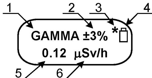
Рис.4 Информация на дисплее, отображаемая в режиме измерений
