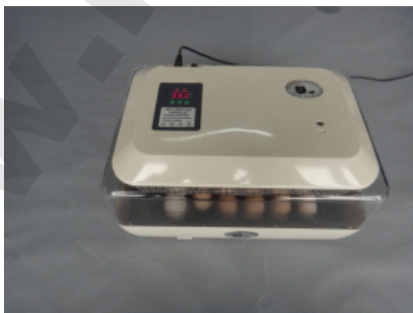
Рис. 6: Если инкубатор не работает (т.е.: не вращается вентилятор, не показывает температуру), то проверьте состояние предохранителя на задней части крышки инкубатора и, в случае необходимости, замените его. Предохранитель может выйти из строя, если инкубатор деформирован или в него попала влага. После включения инкубатора на индикаторе может отображаться знак "L". Для перехода в режим отображения текущей температуры нажмите любую из трёх кнопок на панели управления. Пожалуйста, не изменяйте настройки инкубатора, если вы не уверены, как это делать и для чего это нужно. Заводские настройки температуры позволяют обеспечить высокую выводимость даже без их корректировки. В период вывода вентиляционное отверстие на верхней крышки инкубатора (справа) должно быть открыто полностью.
