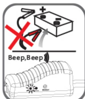
ГОРИТ КРАСНЫЙ СИГНАЛ, ЗВУЧИТ СИГНАЛ ТРЕВОГИ: Подключение неправильное, звучит сигнал тревоги, необходимо проверить правильность подключения зажимов (пункт 2), после появления зеленого сигнала можно заводить двигатель.
