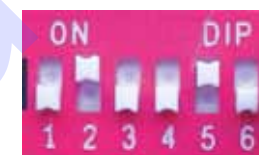
Bloque con 6 conmutadores DIP
