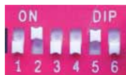
Bloc comprenant les 6 commutateurs DIP
