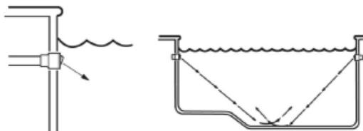
**ВАЖНО:** При подключении последнего элемента (секция шланга, регулятор потока), убедитесь, что он остается под водой, чтобы исключить риск всасывания воздуха и опорожнения насоса.
