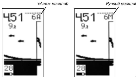
**Режим автоматического выбора масштаба («Авто»)** позволяет прибору самостоятельно определять масштаб при изменении глубины водоема. При движении на лодке (например) прибор будет автоматически переключаться на нужную шкалу глубин, сопровождая это двойным звуковым сигналом и отделяя участки изображения с разным масштабом вертикальным пунктиром. При этом линия дна будет всегда в нижней части экрана.
