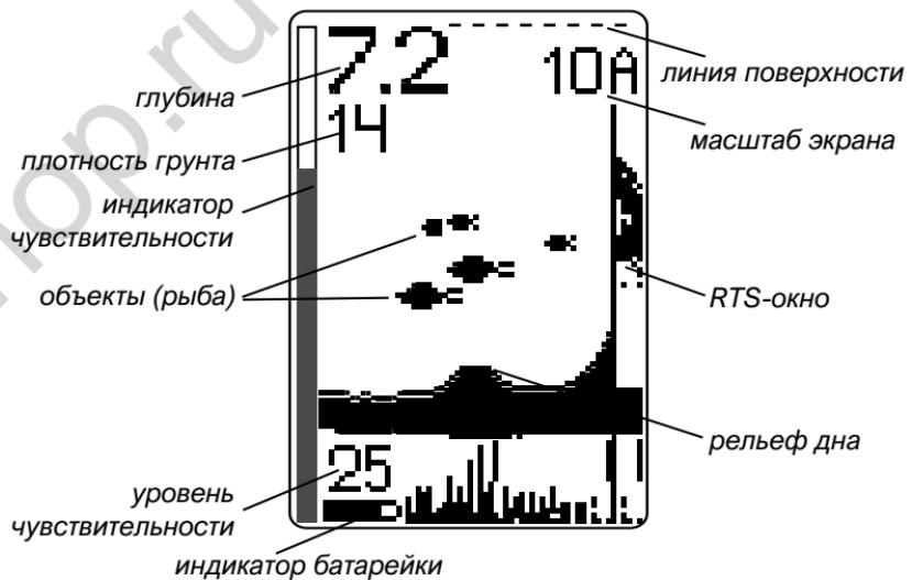
Линия поверхности воды отображается в виде движущейся пунктирной линии.
