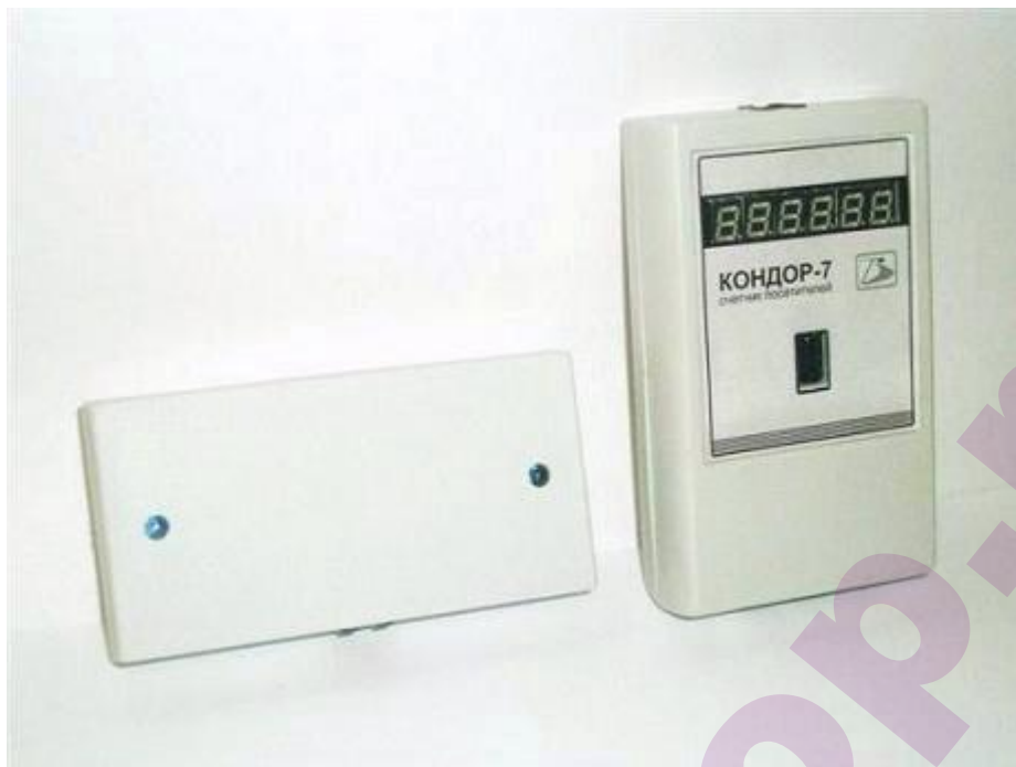
• Рис. 1 Счетчик посетителей Кондор-7: внешний вид.
