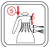
В начале работы настройте рассеивающую гайку, вращая ее вокруг своей оси (тип факела от струи до тумана). Для начала опрыскивания нажмите клавишу.
