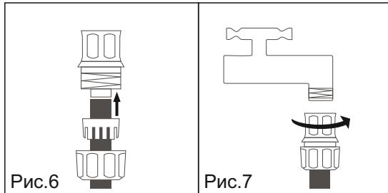
Соедините цанговый зажим (2) с водопроводным краном с наружной резьбой  $\frac{1}{2}$  (см. рис. 7)
