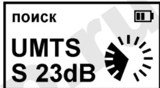
На дисплее отображается сигнал, имеющий максимальный уровень. Аудиоконтроль в режиме поиска возможен только для аналоговых сигналов. Для аудиоконтроля текущего сигнала нажмите кнопку **[OK]** (см. раздел «Аудиоконтроль»).
