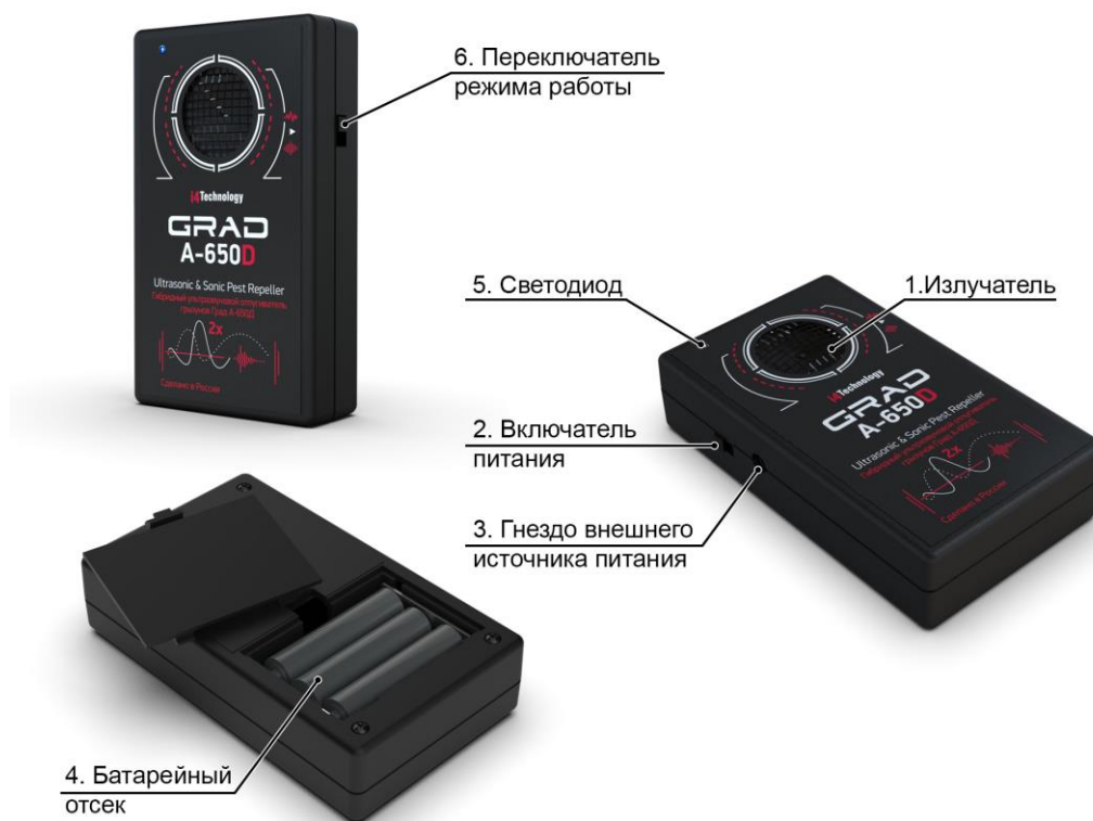
Рисунок 2 – расположение основных частей изделия
